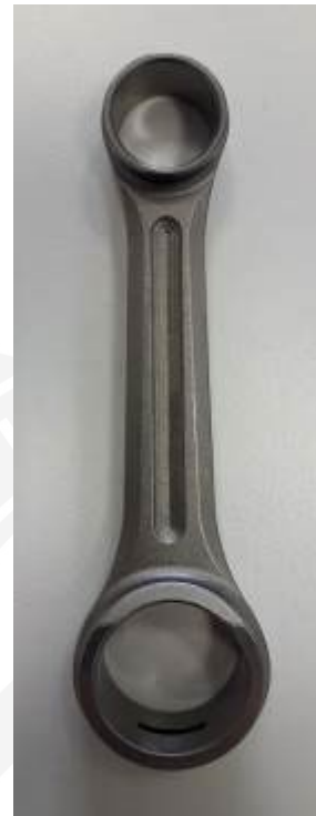
Photo de la bielle gauche / Photo of the conrod left
