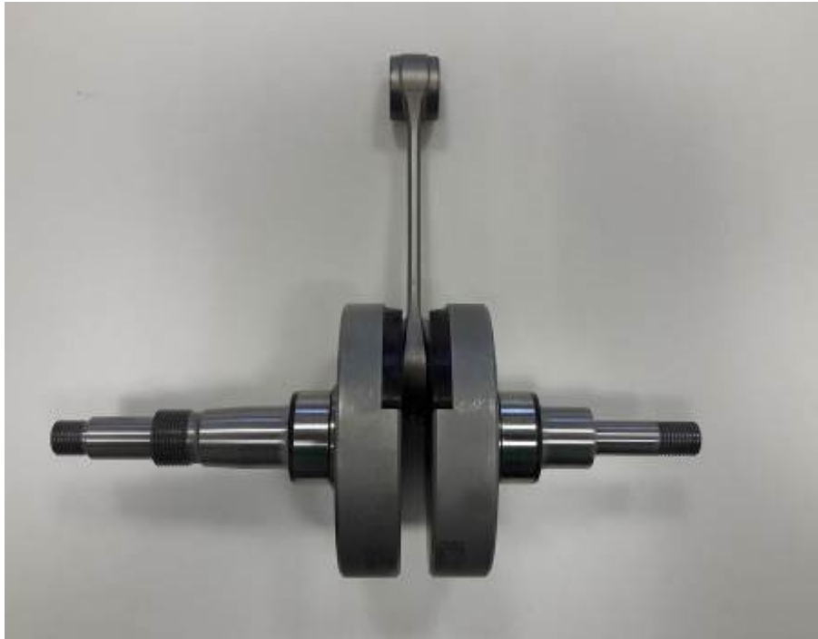
Photo de la bielle droite / Photo of the conrod right
